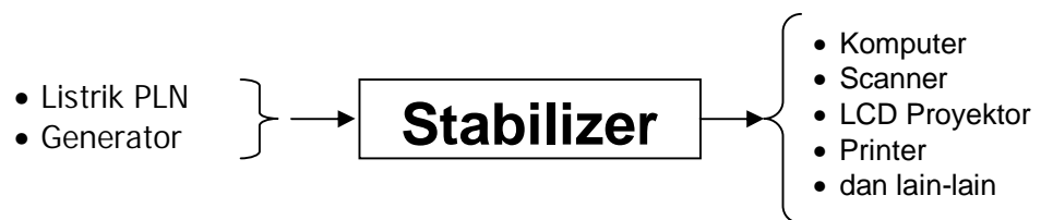
Gambar 2. Bagan Pemasangan Stabilizer
